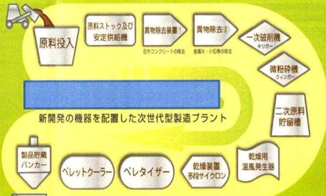
原料投入 → 原料ストック及び安定供給機 → 異物除去装置① (石やコンクリートの除去) → 異物除去② (金属片、小石等の除去) → 一次破砕機 (キリガ) → 微粉砕機 (フィンガ) → 二次原料貯留槽 → 乾燥装置 (多段サイクロン) → 乾燥用温風発生器 → ペレットクーラー → ペレタイザー → 製品貯蔵バンカー
